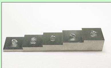
測定物に接触媒質(カプラント)を少量塗布する。
