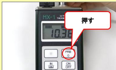
接触媒質(カプラント)を塗布した零点調整用試験片にトランスデューサーを接触させる。
