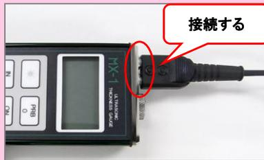
MX-1 (上部コネクタ)と探触子(トランスデューサー)をケーブルで接続する。
