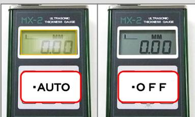
バックライトキーを押す度「AUTO/ON/OFF」が切り替わり、LCDディスプレイを明るくできる。作業環境によってお選び下さい。
