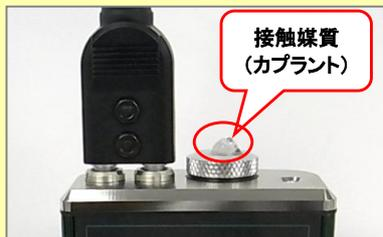
接触媒質(カプラント)を本体上部の零点調整用試験片に少量塗布する。
