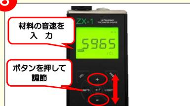
「増加(+キー)」か「減少(-キー)」にて、最終ページの材料音速一覧表を参考し、測定する材料の音速を入力します。
