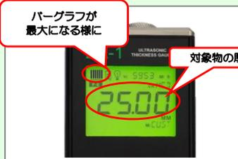
(零点調整と同様に) バーグラフが最大になる様にトランスデューサーを接触させ、測定を行います。
