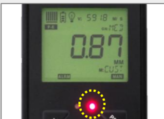
(例) 下限値：1mm、 上限値：3mm 測定値が、下限値の1mmを下回るため、LEDが赤に点灯
