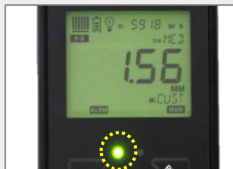
(例) 下限値：1mm、 上限値：3mm 測定値が、下限値の1mmと上限値の3mmの間のためLEDが緑に点灯
